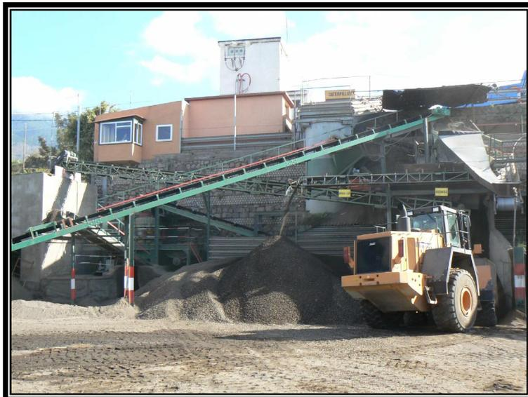
*Observar como va saliendo los áridos, la pala mecánica saca el material*
